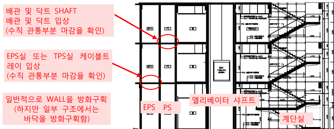
● 그림 1.2.6.1 EPS, TPS, PD 등의 바닥을 기준으로 방화구획(수직방화구획)
